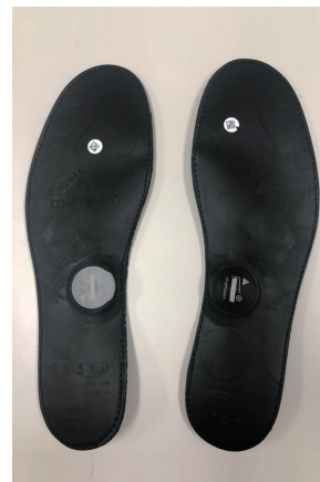
図1. 足圧分布測定器 (tool-the Open Go Sensor Insole : MOTICON 社製、以下足圧インソール)
