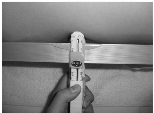
図3② 定規付きプローブでの測定方法
