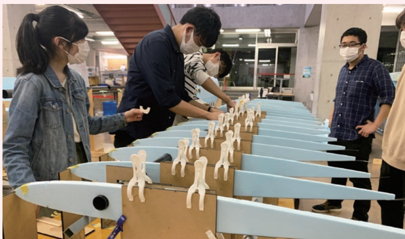
リブセツ（翼の断面を軸に通って接着する作業）を行う増本さん（左）
