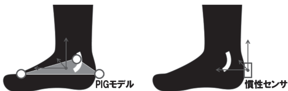
図8 PIGモデルと慣性センサによる足部セグメント座標系の相違
